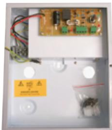
Entwickelt, um 24VDC Türhaltemagneten mit Brandmeldeeingangsrelaissteuerung zu betreiben. Für den Einsatz, wenn kein Batterie-Backup erforderlich ist.
